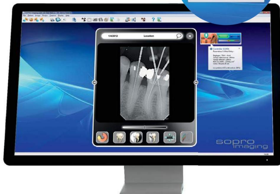
Lorsque vous utilisez le capteur SOPIX® inside combiné au générateur X-Mind® unity, le logiciel SOPRO® Imaging enregistre systématiquement les **paramètres X-Mind® unity** ainsi que la **dose effective reçue par le patient** lors de chaque acquisition, garantissant une **traçabilité permanente** pour tous vos patients.
