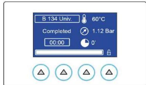
En appuyant sur OK, l'utilisateur confirme le résultat positif du cycle et autorise la prise en charge du matériel stérilisé. On doit choisir l'utilisateur et le PIN correspondant.
