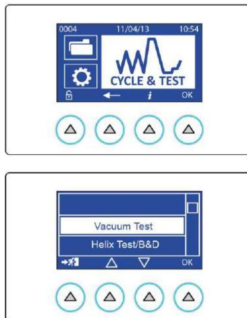
Le cycle doit être exécuté avec la chambre de stérilisation vide, seulement le support porte-plateaux et les plateaux peuvent rester insérés.
