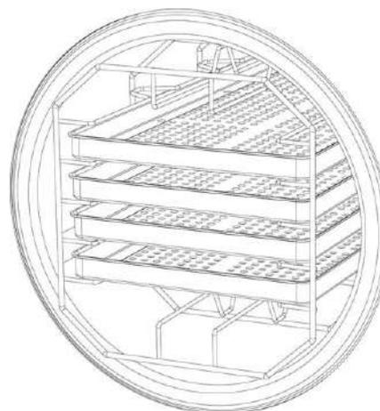
Ou bien, en sortant le support porte-plateaux et en le tournant de 90°, il peut être utilisé pour loger les « boîtiers » (3/4 compartiments selon le modèle de stérilisateur).
