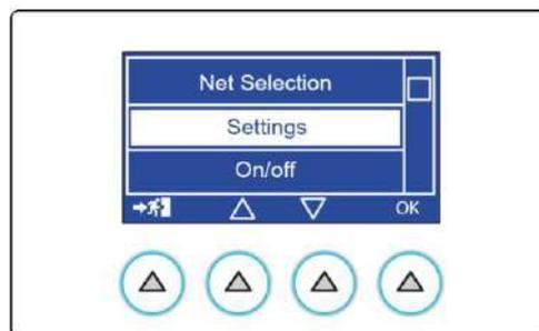
Sélectionner ON/OFF pour activer ou désactiver la connexion Wi-Fi.
