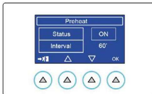
Sélectionner ON pour activer le PRÉCHAUFFAGE.
