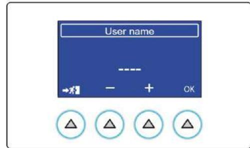
Par les touches + et -, saisir le « sigle » d'identification du nouvel utilisateur, en insérant une lettre à la fois et en confirmant par OK jusqu'à l'achèvement.
