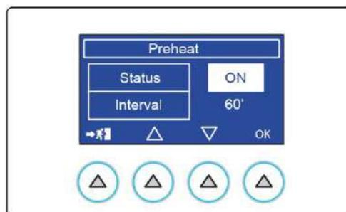
Lorsque le PRÉCHAUFFAGE est actif, la commande INTERVALLE permet de configurer le temps maximum de fonctionnement, après lequel le chauffage est désactivé.
