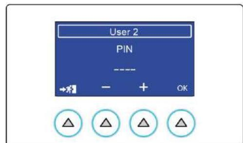
Après la confirmation du PIN, la porte de l'autoclave s'ouvre et la charge peut être enlevée.
