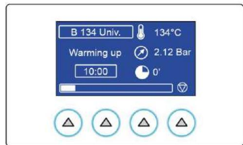
Lorsque la demande du PIN au terme du cycle est programmée, en appuyant sur la touche de déverrouillage de la porte, la page-écran récapitulative des paramètres relatifs au cycle de stérilisation est affichée.
