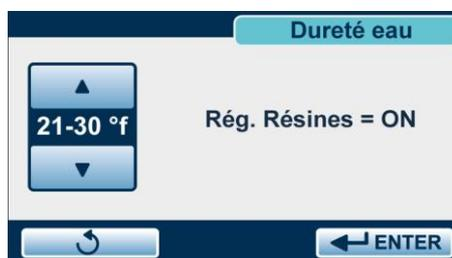
L'indication « régénérat.résines » (ON/OFF) signale si la gestion de la régénération des résines est active et est en fonction de la valeur de dureté programmée.
