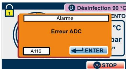
**Toute anomalie**, se produisant pendant le fonctionnement du thermo-désinfecteur provoque la génération d'une indication d'alarme avec un code spécifique (formé d'une lettre suivie d'un numéro à trois chiffres).
