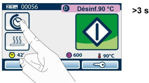
Programmer le temps de retard pour le démarrage. Le temps minimum programmable est de 30 minutes. L'heure de démarrage du cycle est affichée à côté de la commande. Confirmer le réglage effectué en appuyant sur « Enter ».
