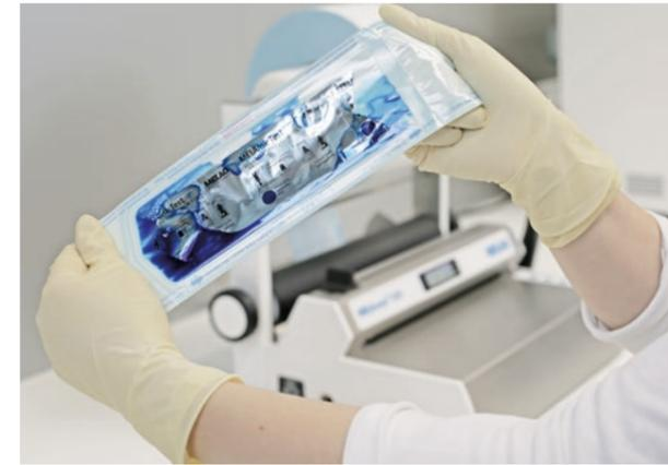
Le test d'encre MELAcontrol® Ink Test est un moyen de **contrôle fiable** permettant de vérifier chaque semaine l'étanchéité des joints scellés conformément aux normes DIN EN ISO 11607-1 et ASTM F1929-12.
